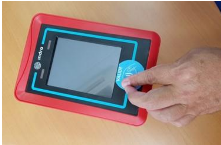
La ONCE comprobó en una de las nuevas validadoras las pegatinas en braille que permiten a las personas invidentes saber dónde deben colocar su tarjeta sin contacto para que el viaje quede validado de forma correcta
