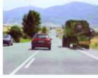
Marcas longitudinales continuas adosadas a discontinuas
