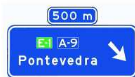
S-232 Preseñalización con señales sobre la calzada en carretera convencional hacia autopista o autovía
