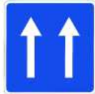
S-11a Calzada de sentido único
