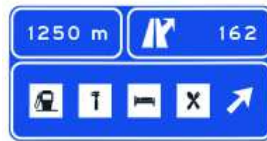
S-263 Preseñalización en autopista o autovía de una zona o área de servicios con salida compartida
