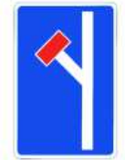
S-15c Preseñalización de calzada sin salida
