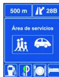
S-271 Preseñalización de área de servicio
