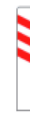
P-10a Proximidad de un paso a nivel, puente móvil o muelle (lado izquierdo)
