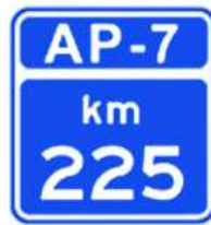
S-570a Hito kilométrico en autopista de peaje
